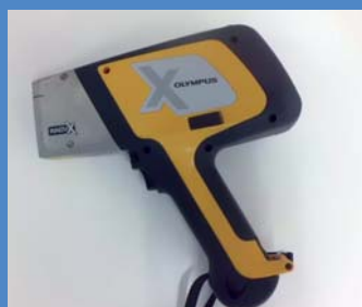
蛍光 X 線分析計 (PMI 検査) OLYMPUS DELTA ALLOY PLUS
